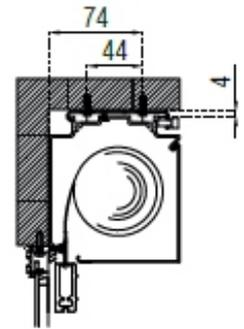
Montaggio a soffitto con supporto
